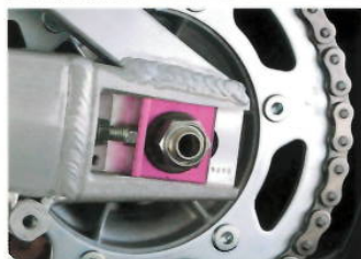
ステアリング廻り、チェーンアジャスターなどに、軽量なアルミ製パーツを多用。
