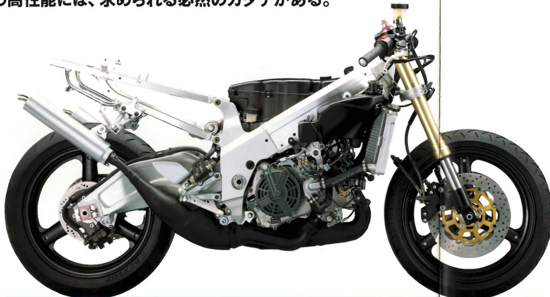
こだわりの骨格。軽量・高剛性、中空構造のアルミツインスパーフレーム。
