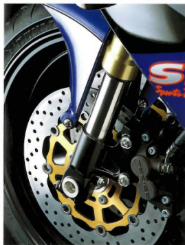
強靱で柔軟。フルアジャスタブルの倒立フロントフォーク。
